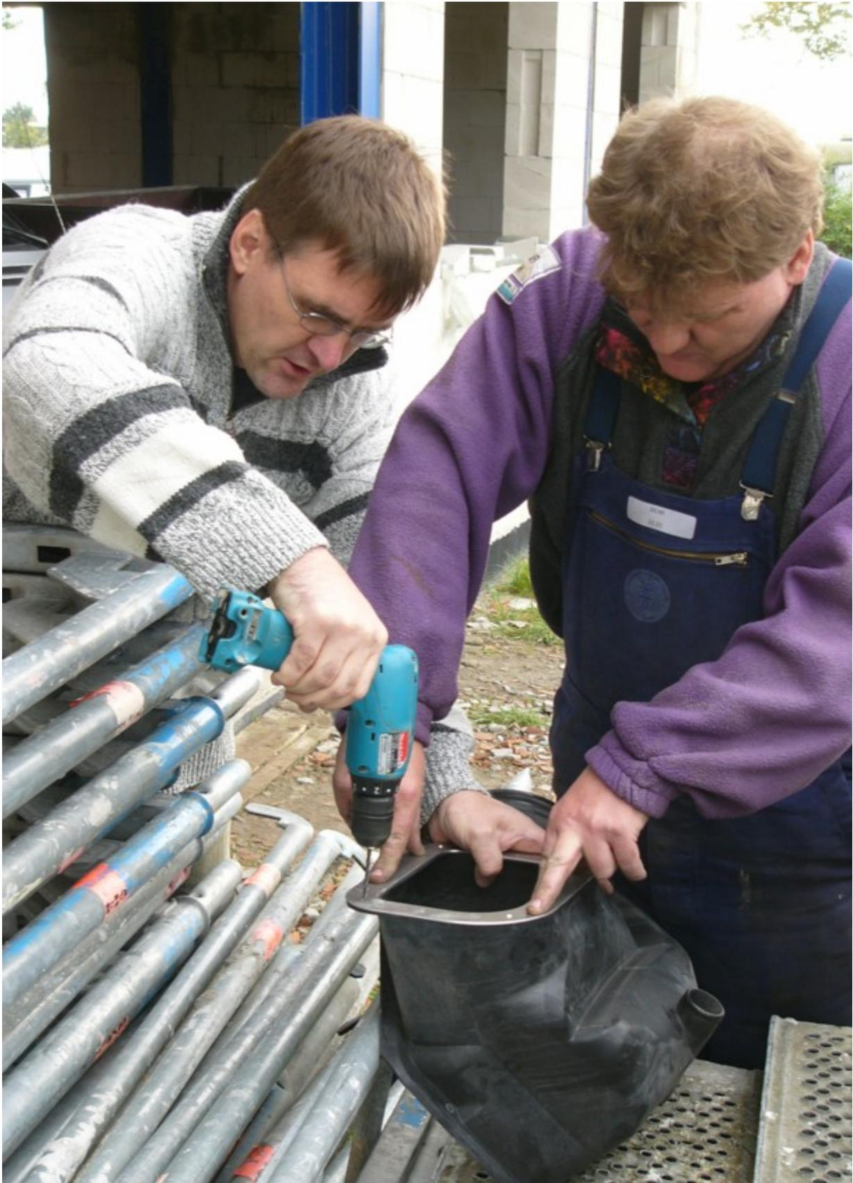
Ist dies geschehen, werden die Löcher mit 7 mm aufgebohrt um
