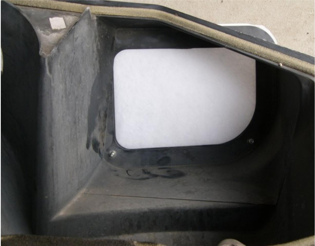
Es ist Vollbracht. Um den Filter jetzt auch nutzen zu können, muß der Kasten wieder an die Motorhaube geschraubt werden, er muß allerdings nicht mehr zum Filterwechsel abgeschraubt werden, dazu reicht es die 4 Schrauben am Rahmen zu entfernen
