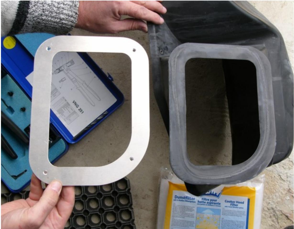
Die Löcher mit einem 4 mm Bohrer auf den Lufteinlass übertragen
