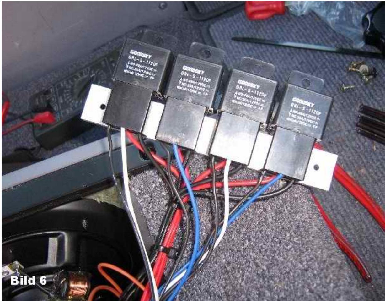
Die roten Kabel der Relaissockel werden zusammengeführt und mit der Plusleitung aus der Fahrersitzkiste verlötet (mit Schrumpfschlauch isolieren). Die schwarzen Kabel der Relaissockel zusammenführen, mit den beiden braunen Adern der Sitzheizelemente verlöten und an Masse legen (Bild 7 – rote Pfeile). Das Alu-Profil mit Sockeln und eingesteckten Relais in der Beifahrersitzkiste, die wir zwischenzeitlich wieder eingebaut haben, befestigen (Bild 7)
