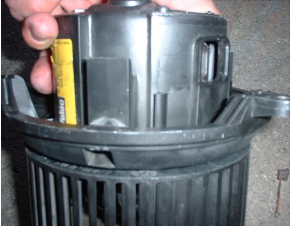
Nun sieht man auf der äußeren Hülle 3 Öffnungen, die man am Besten mit einem grossen Schlitzschraubenzieher etwas ablöst und so trennt..... das Gehäuse ist nun offen.
