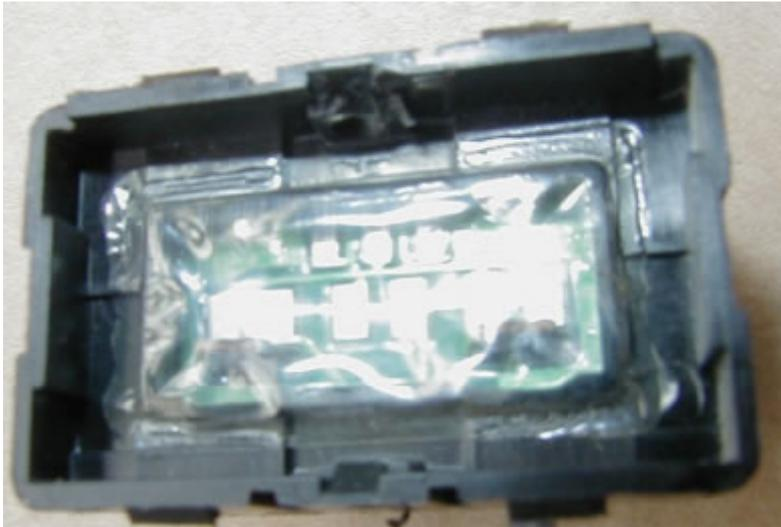
Die Schalter-Elektrik dann vorsichtig aus dem Gehäuse herauslösen. Dann sollte das was vor Ihnen liegt so aussehen wie auf dem Bild unten.
