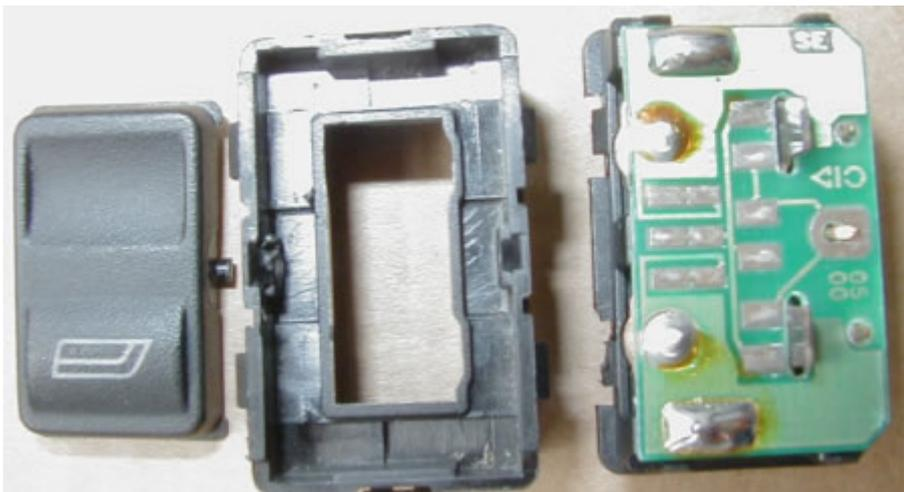
Pro Schalter werden eine LED (empfohlen wird eine sehr lichtstarke LED, da die Schalterwippe viel Licht schluckt) und ein Vorwiderstand gebraucht.
