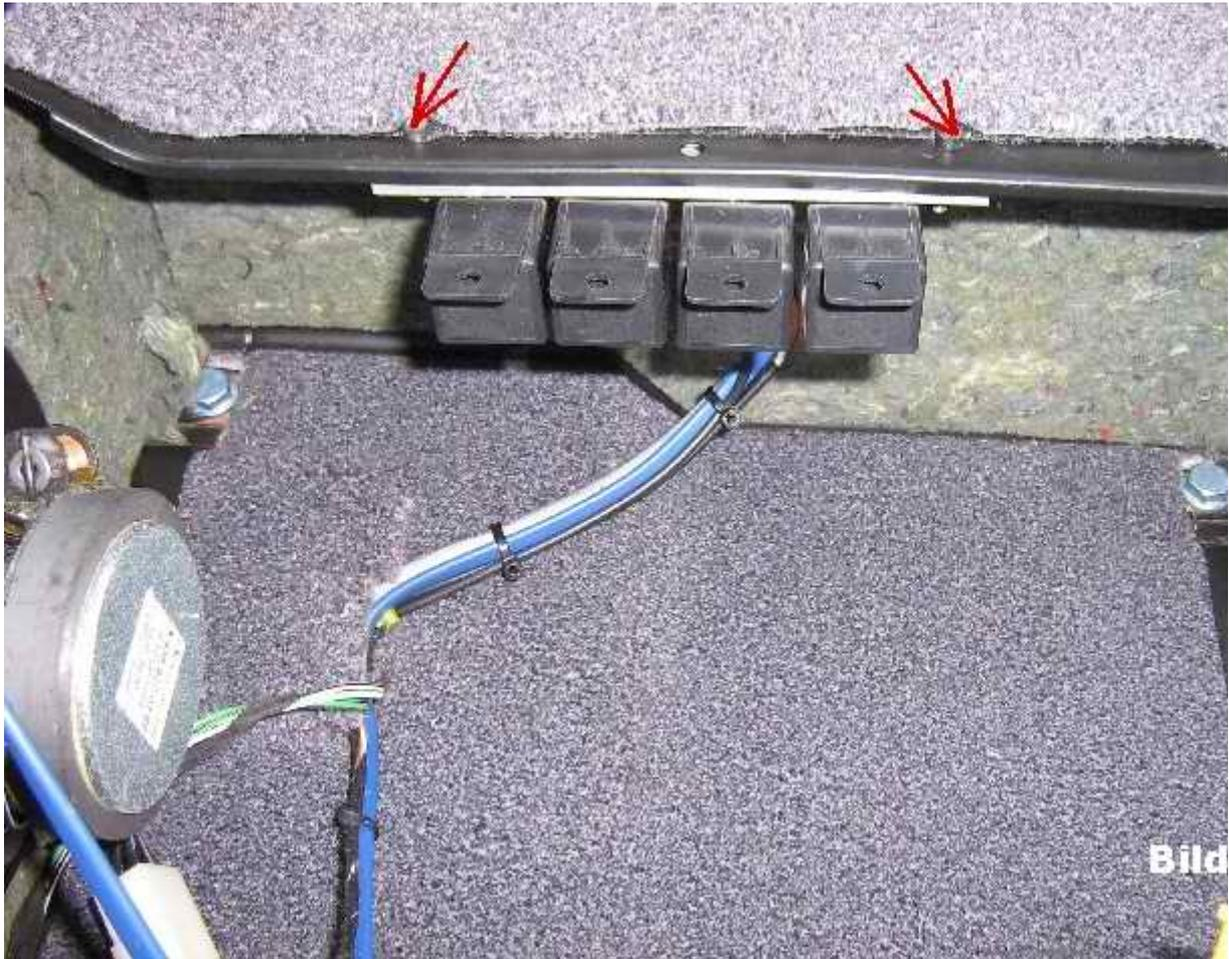
Die Fahrersitzkiste wieder festschrauben. An die vier Adern der Steuerleitung im Zentralpaneel kommen Flachsteckhülsen 2,8mm. Die passen an die Original-DC-Schalter. So habe ich mir die Stecksocket gespart. Anschluss gemäß Schaltplan(Bild 8)
