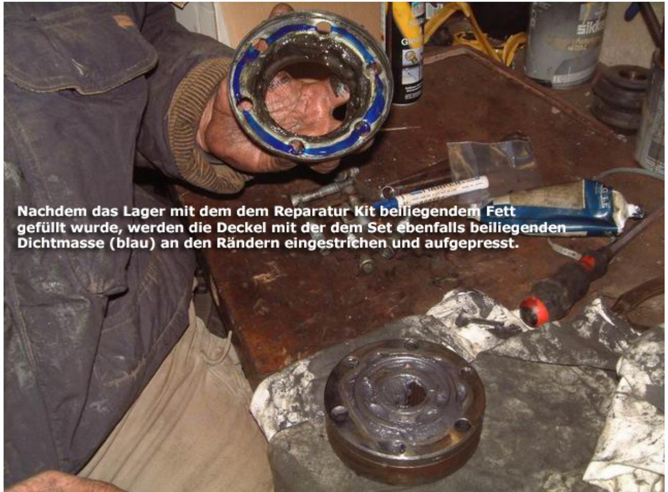
Nachdem das Lager mit dem dem Reparatur Kit beiliegendem Fett gefüllt wurde, werden die Deckel mit der dem Set ebenfalls beiliegenden Dichtmasse (blau) an den Rändern eingestrichen und aufgepresst.
