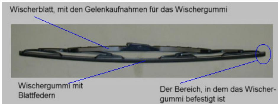
Das Wischergummi wird von den Gelenkaufnahmen der Wischerblattes getrennt.
