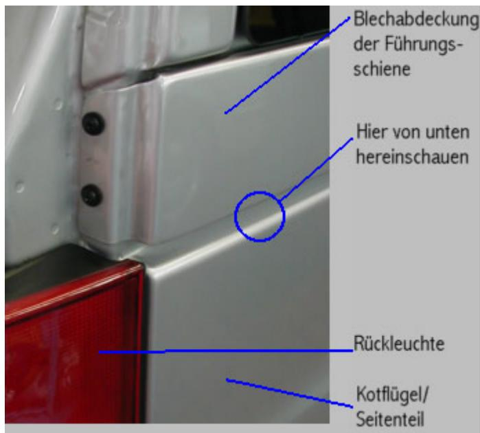
Nach dem Entfernen des lackierten Sichtschutzes ist die Führungsschiene genauer zu Erkennen
