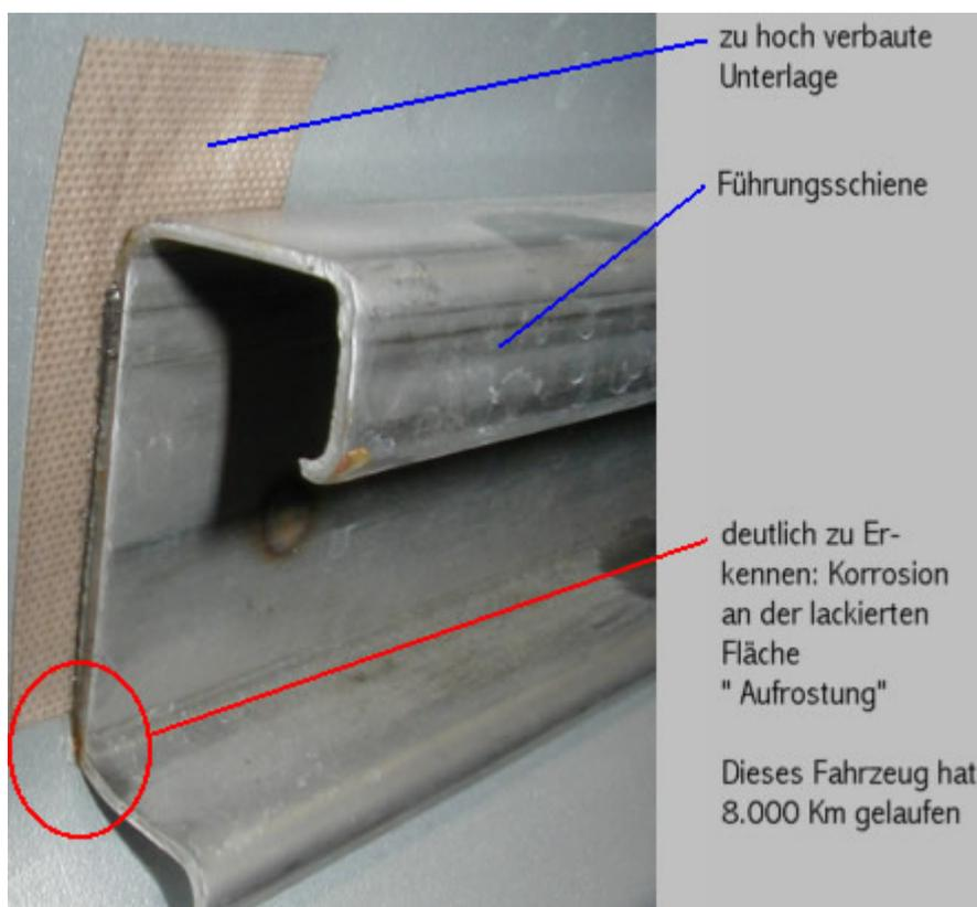
Wenn die Schiebetür bis zu Anschlag geöffnet wird, dann wird die Führungsschiene durch das hohe Gewicht der Schiebetür in die lackierte Fläche des Seitenteils gedrückt.
