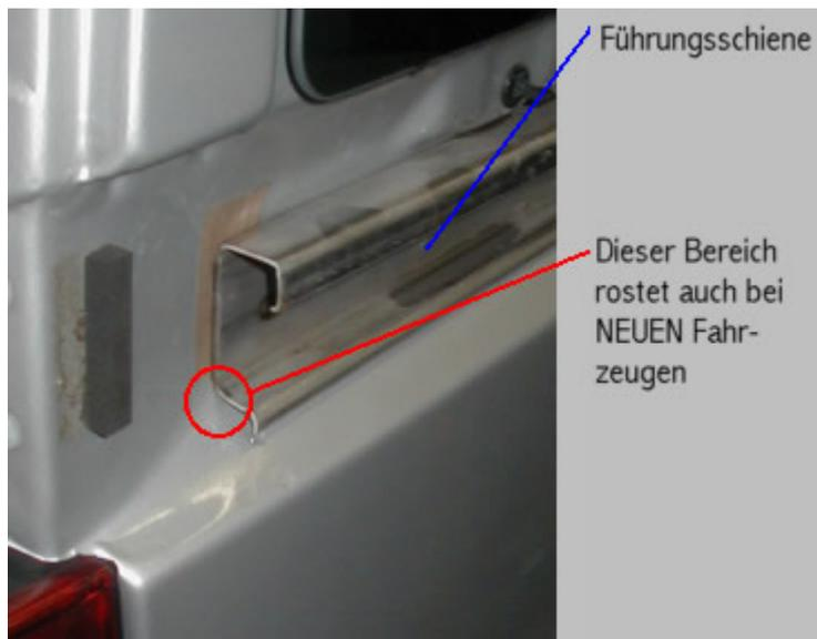
Auf der vierten Bildarstellung ist deutlich zu Erkennen, daß die Unterlage, die den Kontakt mit lackierten Teilen verhindern soll, deutlich zu weit oben montiert wurde.
